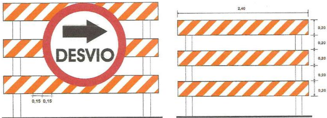
Figura 4.1 Barricadas (dimensiones en metros)
