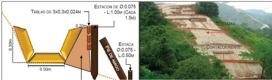
Figura 22. Estructura de las terrazas vivas. a. Dimensiones de un cortacorriente. b. Imagen del establecimiento de terrazas y la construcción de contracorriente
